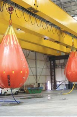
Indoor Crane Test ( 2 x 20 ton )
